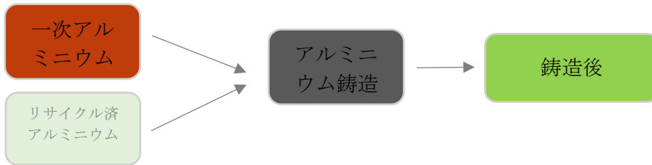
図2 - 材料のフローの主要段階、鋳造工場を中心として
