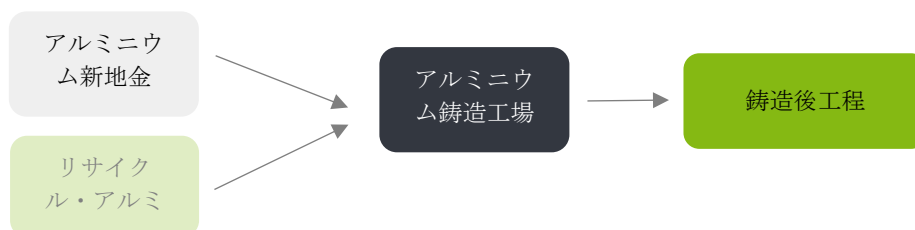
図2－鋳造工場を中心とした材料のフローの主要段階
