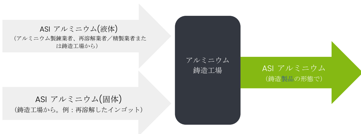
図8 - 「鋳造工場」の「流入」および「流出」
